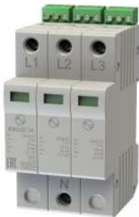
Трехполюсные УЗИП класса испытаний I, II, III ограничивающего типа на основе метало-оксидных варисторов предназначены для защиты электрооборудования, подключенного к проводникам L- PEN, L-N, L-PE однофазных или трехфазных низковольтных силовых распределительных сетей с системами заземления типа TN-C и TN-S, а также к проводникам L-N в системах TT и IT.
