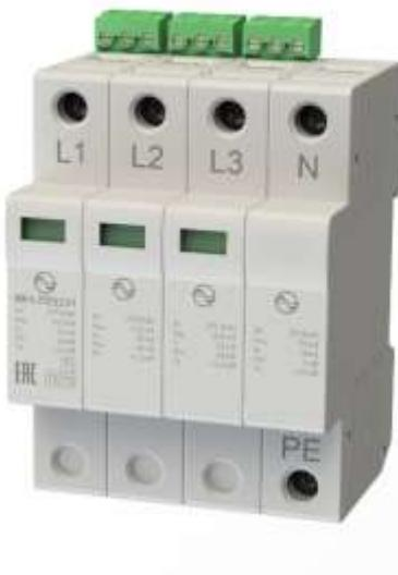
Четырехполюсные УЗИП класса испытаний I, II, III комбинированного типа предназначены для защиты электрооборудования, подключаемого к проводникам в цепях L-N и N-PE однофазных или трехфазных низковольтных силовых распределительных сетей с системами заземления типа TN-S и TT. УЗИП применяются в качестве первой ступени защиты при кабельном и воздушном вводе электропитания.
