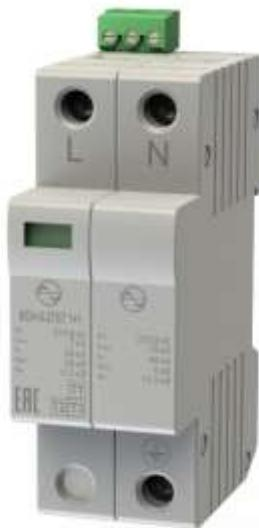
Двухполюсные УЗИП класса испытаний I, II, III комбинированного типа предназначены для защиты электрооборудования, подключаемого к проводникам в цепях L-N и N-PE однофазных или трехфазных низковольтных силовых распределительных сетей с системами заземления типа TN-S и TT. УЗИП применяются в качестве первой ступени защиты при кабельном и воздушном вводе электропитания.
