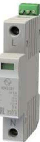
Однополюсные УЗИП класса испытаний I, II, III ограничивающего типа на основе метало-оксидных варисторов предназначены для защиты электрооборудования, подключенного к проводникам L-PEN, L-N, L-PE однофазных или трехфазных низковольтных силовых распределительных сетей с системами заземления типа TN-C и TN-S, а также к проводникам L-N в системах TT. УЗИП применяются в качестве первой ступени защиты при кабельном и воздушном вводе электропитания.
