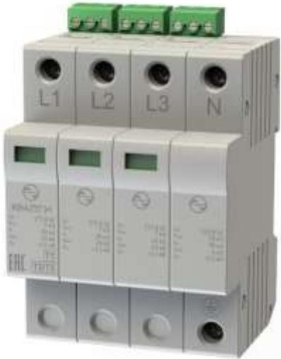
Четырехполюсные УЗИП класса испытаний I, II, III комбинированного типа предназначены для защиты электрооборудования, подключаемого к проводникам в цепях L-N и N-PE однофазных или трехфазных низковольтных силовых распределительных сетей с системами заземления типа TN-S и TT. УЗИП применяются в качестве первой ступени защиты при кабельном и воздушном вводе электропитания.
